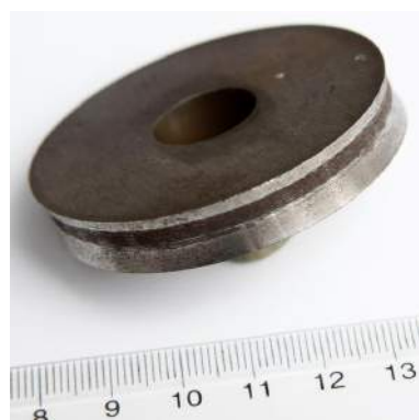
Fig. 4.10. Rola nr. 2 uzată și canelată. Rolă prelevată din material de roată
