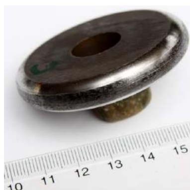
Fig. 4.11. Rola nr. 3 uzată și canelată. Rolă prelevată din material de roată
