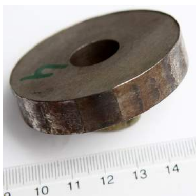
Fig. 4.8. Rola nr. 4 uzată și poligonalizată. Rolă prelevată din material de șină
