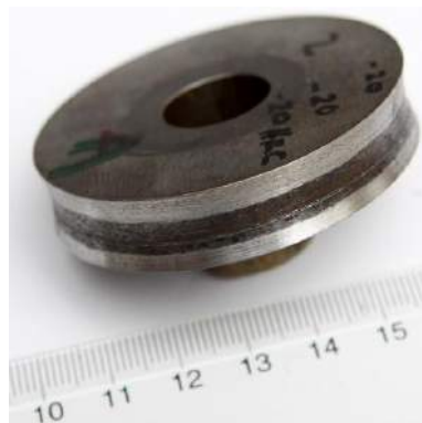
Fig. 4.9. Rola nr. 1 uzată și canelată. Rolă prelevată din material de roată
