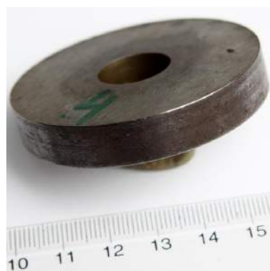
Fig. 4.12. Rola nr. 4 uzată și canelată. Rolă prelevată din material de roată
