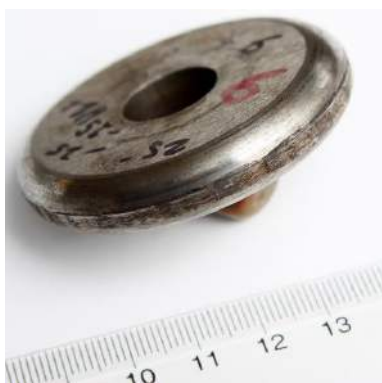
Fig. 4.6. Rola nr. 2 uzată și poligonalizată. Rolă prelevată din material de șină
