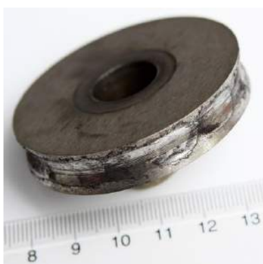
Fig. 4.7. Rola nr. 3 uzată și poligonalizată. Rolă prelevată din material de șină
