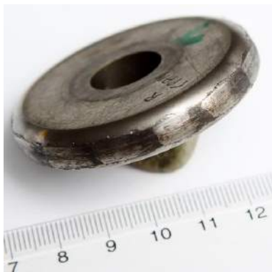
Fig. 4.5. Rola nr. 1 uzată și poligonalizată. Rolă prelevată din material de șină
